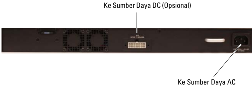
Gambar 1-10. Koneksi Daya AC dan DC ke sebuah Switch N1548
